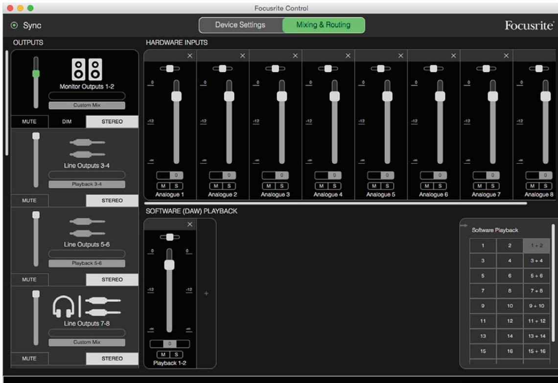
2チャンネルアナログプリセットについては、まとめられたミキサーの出力がモニター出力1と2、および、ライン出力7～10にステレオペアとしてルーティングされます。
