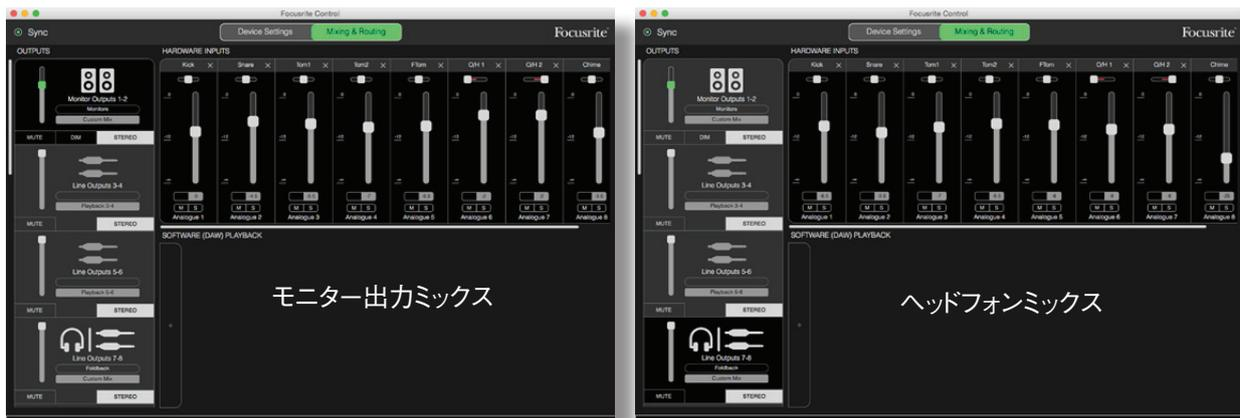
いずれのプリセットを読み込んだ場合にも、ヘッドフォン出力から聞こえるミックスは、メインモニターのミックスと同じものです。ただし、それらは独立しており個別にコントロールが可能です。例えば、演奏者のフォールドバック用にヘッドフォンを使用したい場合、様々なミックスを設定する必要があるはずですが、ヘッドフォンの出力タブ（Scarlett 18i20 の例では**Line Out7 ~ 8**）を選択するだけでミックスを変更することができます。同じ要領で、さらに Line Outタブを使用して **Custom Mix** を選択することで、他の演奏者用に別のミックスを作成することができます。
