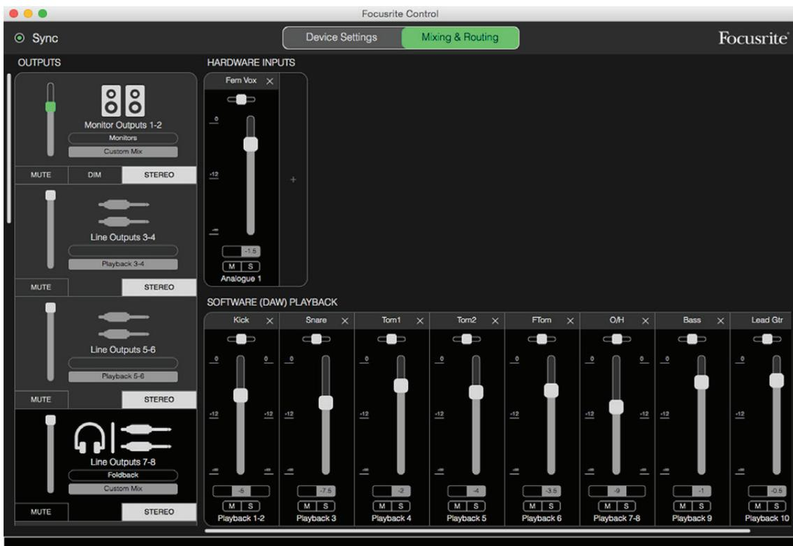
トラックの例と同様に、モニター出力とヘッドフォン出力の両方から聞こえる最初のミックスは、既にユーザーがレコーディングした全てのトラックのラフなミックス（フェーダーがゼロ位置）です。希望に応じて、オーバーダビング中の楽器やレコーディング済みの他のトラックのヘッドフォンから聞こえるレベルを調整することができます。
